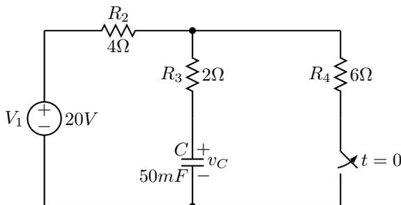
3. Nel circuito in figura in regime stazionario, calcolare la tensione  $V_{AB}$ .
